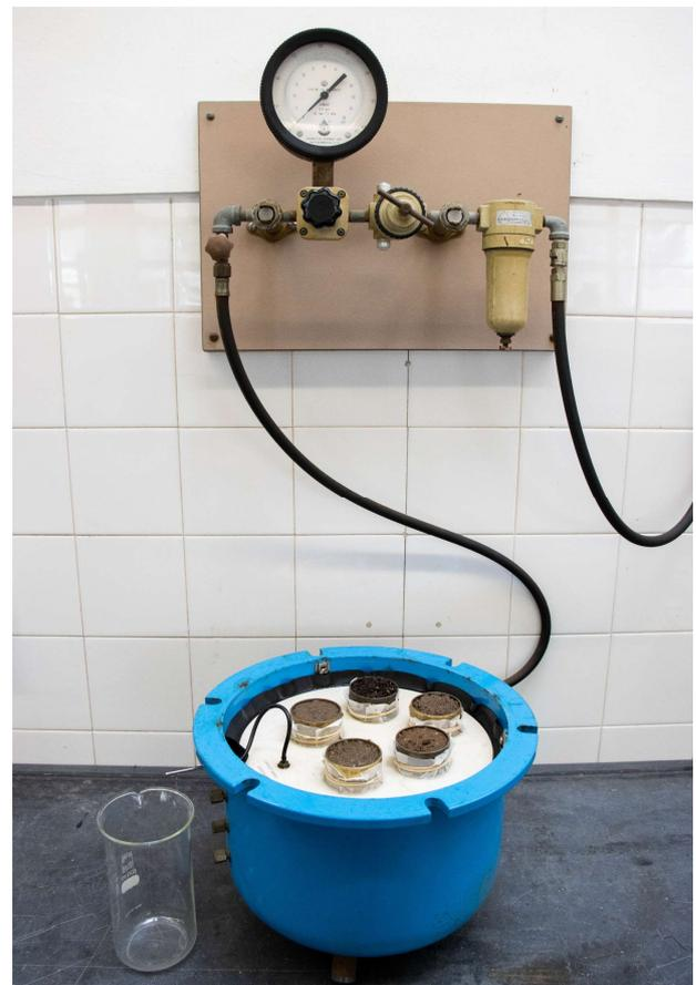
Figura 2. Amostras de terra não perturbadas e saturadas sobre a placa de cerâmica, dentro da câmara de pressão, para determinação de CC e de CE.
