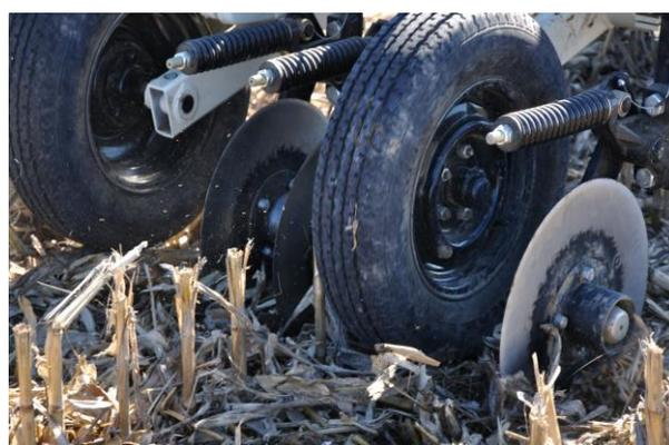
Figura 2. Pormenor do contacto dos eléttodos com o solo
